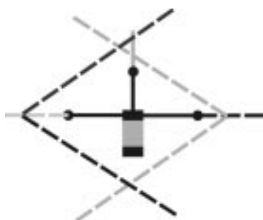
Рис. 8. «Оттяжка» проводников за межслойные переходы
