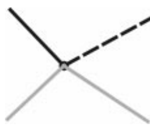
Рис. 10. Добавление в «сером» слое сегмента, соединяющего межслойные переходы, позволяет убрать один из переходов
