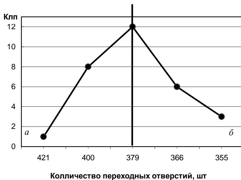
Рис. 3. График зависимости коэффициента качества сигнала от количества переходных отверстий
