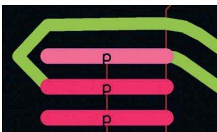
Рис. 10. Выделение функционально эквивалентных контактов
