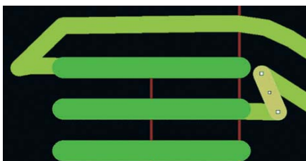
Рис. 12. Ликвидация нарушений после переименования контактов
